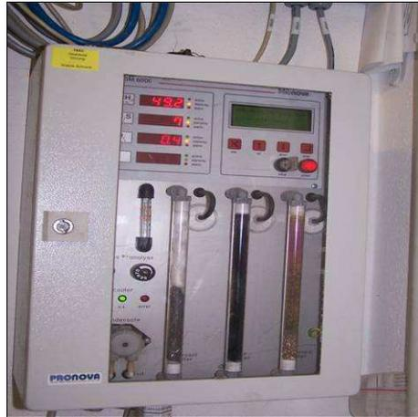
**Photo 7:** Analyseur de biogaz
